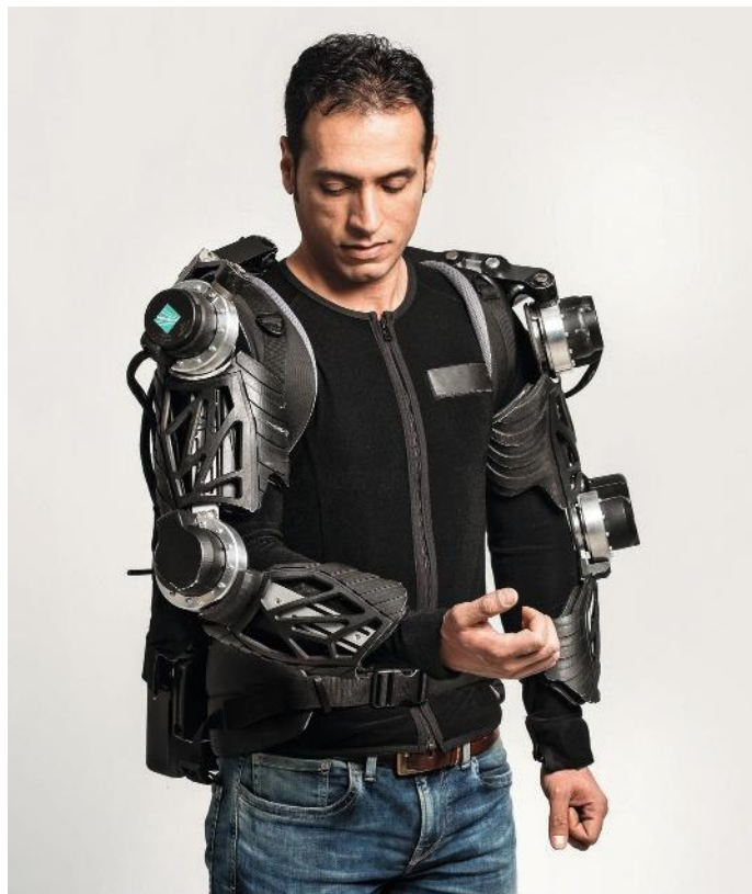
Exo-Skelette verstärken die menschliche Muskelkraft und entlasten so Schwerstarbeiter
